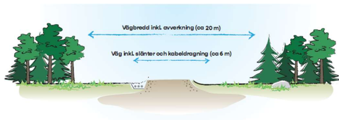
Figur 14. Nyanlagd väg i Marker Vindpark i Norge samt illustration som visar vilken vägbredd som behövs i en vindpark.
