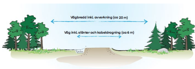
Figur 11 Nyanlagd väg i Marker Vindpark i Norge samt illustration som visar vilken vägbredd som behövs i en vindpark
